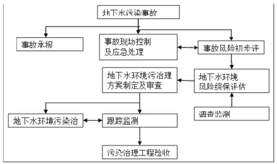
图 7.6-1 地下水污染事故处理程序框图
